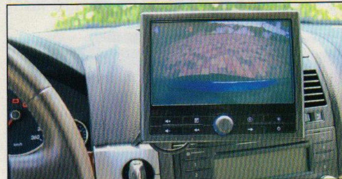
Ausblick: Auch eine Rückfahrkamera lässt sich am Auto-Computer anschließen. Rückwärts einparken wird damit regelrecht zum Kinderspiel.
