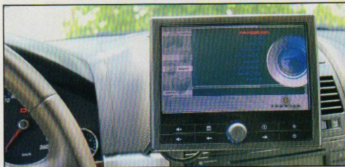
Komfortprogramm: Das Auswahlménú auf dem Touchscreen ist auch über einen Drehregler bedienbar und wirft mit seiner Beschriftung keinerlei Fragen auf.
